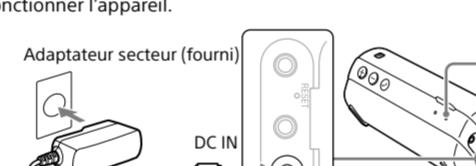
Le chargement démarre lorsque l'appareil est connecté à une prise secteur via l'adaptateur secteur et le témoin de CHARGE (orange) s'allume. Le chargement dure environ 3 heures et le témoin s'éteint.
