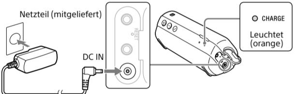
Der Ladevorgang beginnt, sobald das Gerät über das Netzteil mit einer Steckdose verbunden ist und die CHARGE-Anzeige (orange) leuchtet. Das Ladebild ist nach etwa 3 Stunden abgeschlossen, und die Anzeige erlischt.
